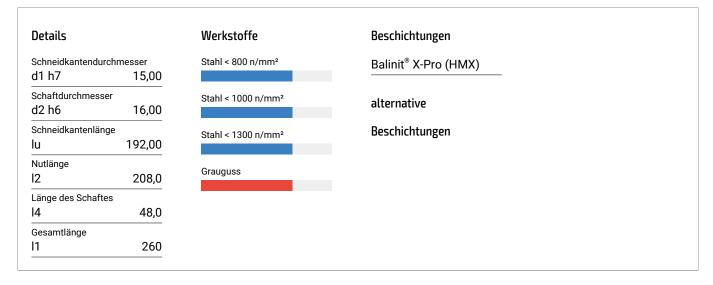
Dieses Werkzeug ist verfügbar mit 58 Durchmessern.
