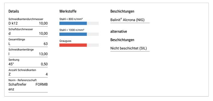
Dieses Werkzeug ist verfügbar mit 9 Durchmessern und 2 Beschichtungen.
